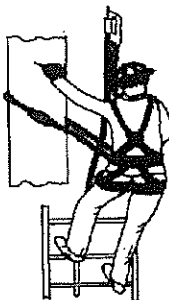
Fig. 3 Utilizarea frânghiei de acces, cu opritor de cădere alunecător, în lipsa elementelor fixe de pe stâlp
