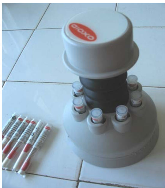
Fig. nr. 71 Dispenser mecanic pentru repartizarea microcomprimatelor
