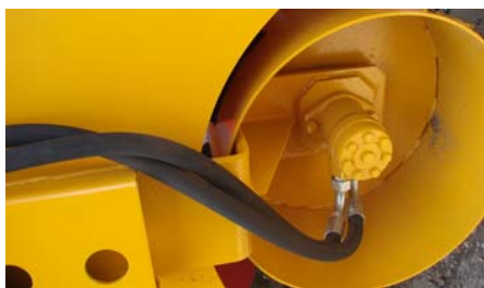
Figura 7 Motorul hidraulic orbital OMP 100 pentru antrenarea rotorului frezei
