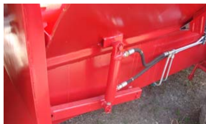
Figura 8 Cilindrii hidraulici pentru acționarea oblonului benei
