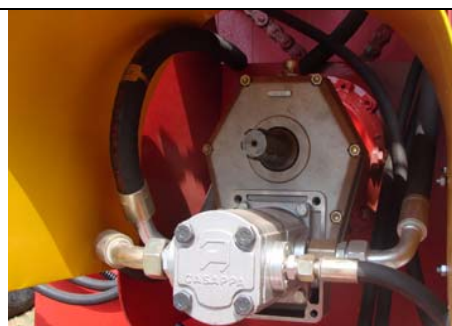
Figura 1 Grupul de antrenare pentru echipamentul tehnologic MF 8
