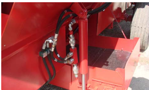
Figura 9 Cilindrii hidraulici pentru acționarea tronsonului rabatabil al transportorului și a șibărului
