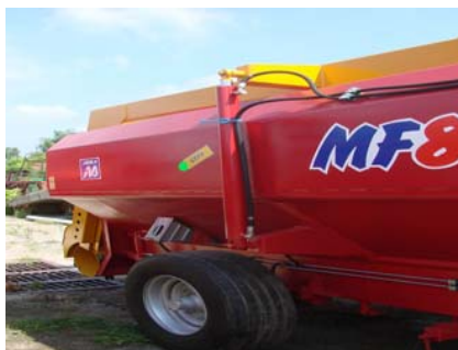
Figura 6 Cilindrii hidraulici pentru acționarea brațului port-freză
