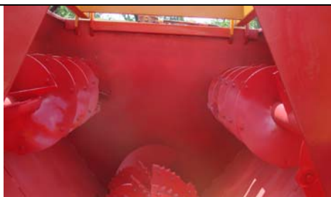
Figura 3 Ansamblul melcilor de tăiere și amestecare a componentelor rețetei furajere
