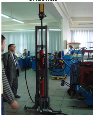
Figura 3 Dispozitiv de testare servomecanism hidraulic de reglare a poziției cu reacție prin laser, destinat echipării utilajelor terasiere de nivelare
