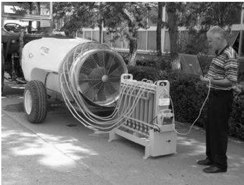
Figura 2. Verificarea parametrilor funcționali ai unui echipament de stropit în vii și livezi de tip ATOM 1000, cu standul realizat
