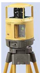
Fig.2 Emițător laser cu auto-orizontalizare
