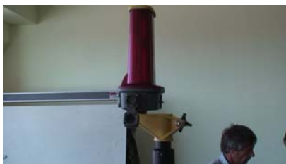
Fig.3 Receptor laser fixat pe suportul telescopic
